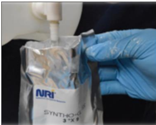
Foto 8 en 9 - Vullen en weken van syntho-Glass band
