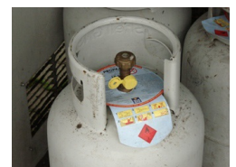
Nieuwe verzegelde gasfles
